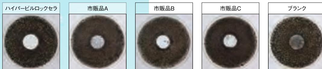
カビ抵抗試験においてハイパービルロックセラは、塗膜表面にカビが生えることなく、すぐれた防カビ性能を発揮します。
