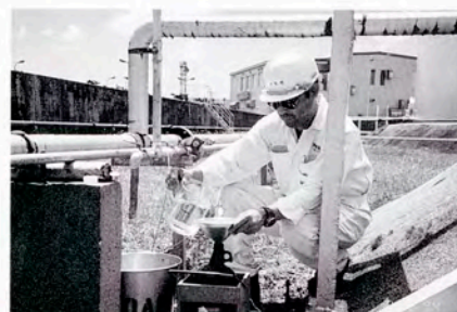
タンク底部ドレインからのサンプル採取
