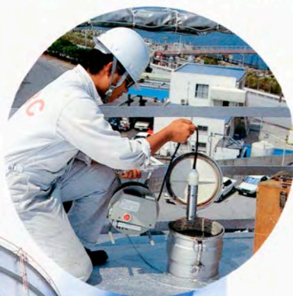
主タンク内燃料の電導度を測定
