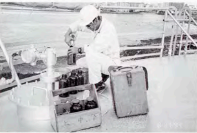
タンクの定点サンプルの採取
