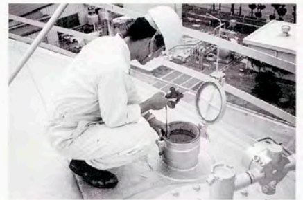
手検尺にてタンクの液面測定
