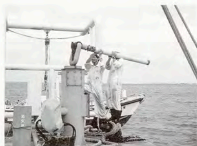
泡消火銃の取り外し
