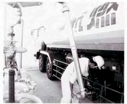
ローディングアームの給油車への接続
