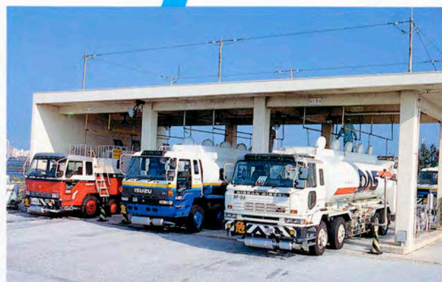
充填場で積込中のレフューラー
