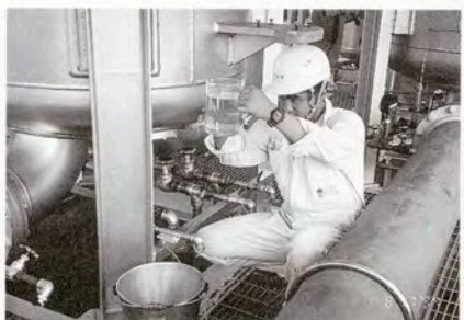
燃料サンプルの目視検査
