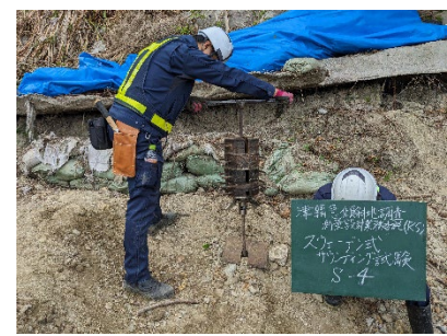
スクリーウエイト貫入試験状況 津覇急傾斜地調査測量設計 業務委託（R5） （中部土木事務所）
