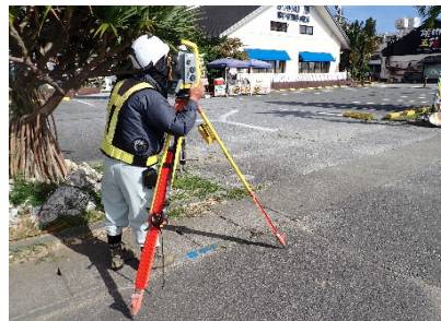
基準点測量 令和3年度南部国道管内改築関係 測量調査設計（その1）業務 （南部国道事務所）
