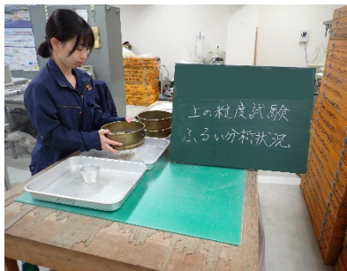
土質試験室 土の粒度試験（ふるい分析状況）
