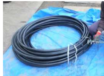
④ 一般用ポリエチレン管 (農業用ポリエチレン管) 呼び経 25 mm 1層管
