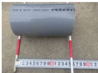
⑤ 止水板 塩ビ管 VP75 L=150 mm
