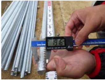
① ネジ節棒鋼 表面処理:HDZ55
