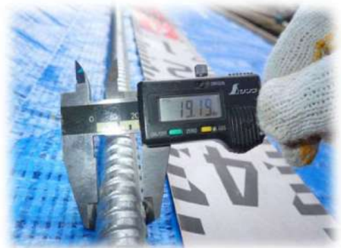
補強材 D19mm 溶融亜鉛メッキ加工
