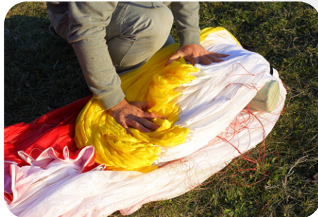
図5. リーディングエッジ先端から80cmあたりにフォールディング枕をストラップで取り付け、リーディングエッジ側を折りたたみます。枕はたたむ角度を緩やかにしプラスチックワイヤーが曲がらない様に保護してくれます。次にトレーリングエッジ側をたたんだリーディングエッジの上に緩やかな角度で折り重ねます。
