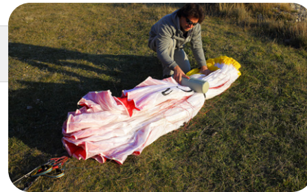
図4. リーディングエッジからトレーリングエッジまでが整頓されたら、グライダーを横向きにします。
