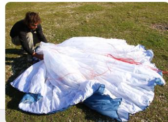
図3. ひとまとめになったリーディングエッジをバックアップベルトで固定します。グライダーをセンター部分で半分に折り重ねずに、翼端から翼端まですっかり蛇腹折りにします。真中のセルを無理に引っ張ったりプラスチックワイヤーを变形させたりしないように慎重に行ってください。
