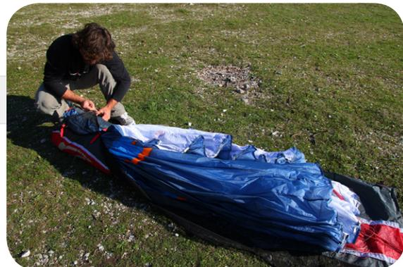
図8. フォールディング枕を適当な位置に取り付け、三つ折りでリーディングエッジとトレーリングエッジをたたみます。
