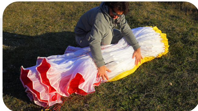
図3. B,Cライン取り付けタブを利用してグライダーの中央から後方部分をひとまとめにします。
