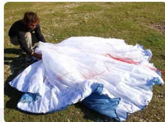
**図3.** ひとまとめになったリーディングエッジをバックキングベルトで固定します。グライダーをセンター部分で半分に折り重ねずに、翼端から翼端まですっかり蛇腹折りにします。真中のセルを無理に引っ張ったりプラスチックワイヤーを变形させたりしないように慎重に行ってください。
