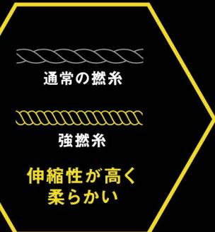
強撚糸を使った特許取得の独自製法を用いた糸巻きチューブ構造を採用。糸巻用撚糸の撚り数を変更したものを使用しているため伸縮性が高く、当社従来品より柔らかく、選手への負担も少なくなりました。
