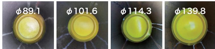
鋼管プラキャップに破損なし。鋼管内部へのコンクリート漏れは確認されず
