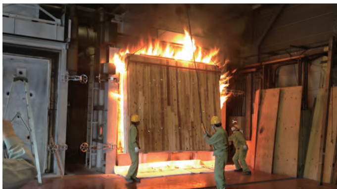
木材厚板のCLT（直交集成板）の加熱実験
