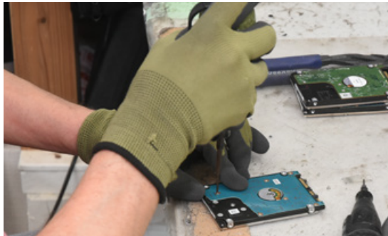
PCから基盤を取り外し、ハードディスクもネジを外して分解する
