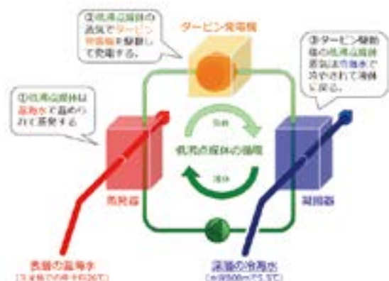
海洋温度差発電のイメージ図(GOSEA提供)
